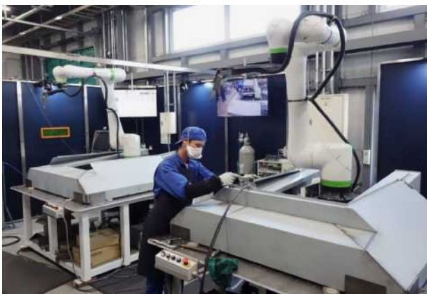
スズキ工場で溶接を担当する協働ロボット
